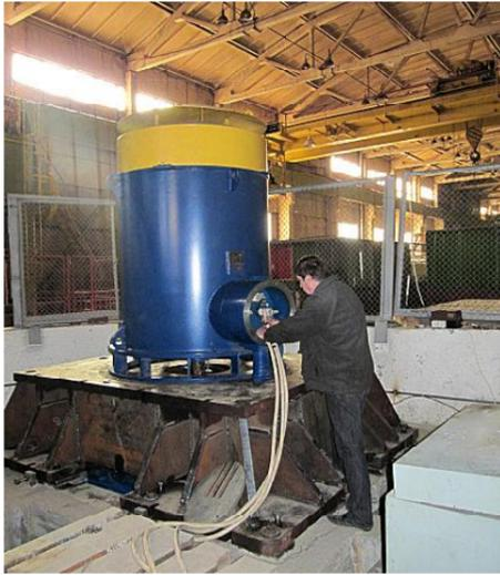
На НП ЗАО «Электромаш» завершены строительно-монтажные работы и сдана в эксплуатацию испытательная станция ИС-2000, предназначенная для проведения испытаний под нагрузкой крупных асинхронных электродвигателей с техническими параметрами:
