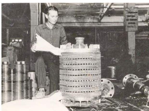
Нач. ОТК Олейник В.С. проводит проверку первого литого ротора ВАО142-4 (630 кВт, 6кВ, 1500 об/мин)
